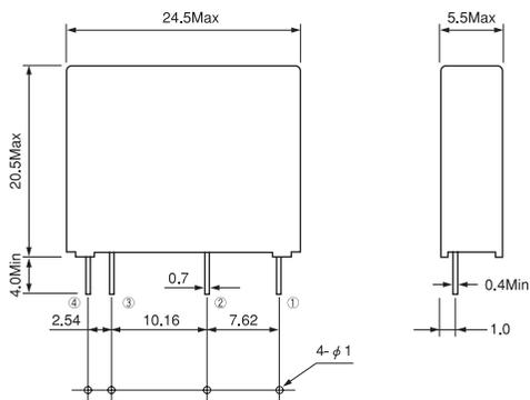
プリント基板取付寸法図(参考)
