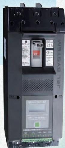
当社開発の「
