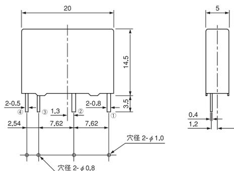
プリント基板取付穴寸法図 (参考)
