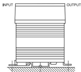
※ 4台以上密着取付けの場合、負荷電流定格を10%以上低減して御使用下さい。
